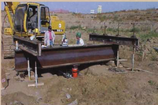
Šroubové vrtané mikropiloty: testováno do 205 tun
