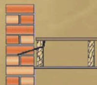
12. Nahrazování sendvičových kotev
