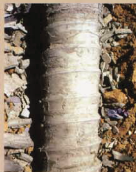
Detail šroubové vrtané mikropiloty vytažené z půdy
