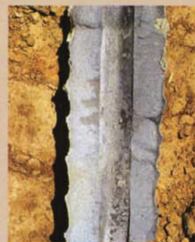
Příčný řez vytažené mikropiloty
