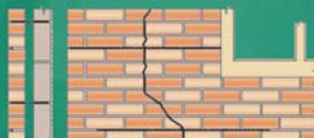
7. Opravy trhlin v blízkosti rohů a otvorů
